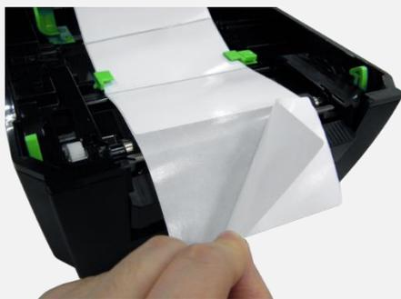
3. 开启打印机上盖。移除几张标签留下底纸。
