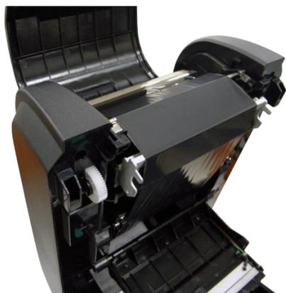
7. 将碳带绕过打印头，平整的黏贴在空标签上。
