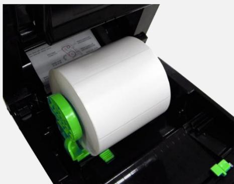
3. 将标签放置入标签夹持座中并确认有将其套入标签轴心。
