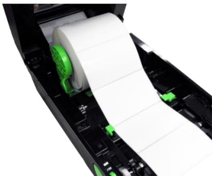
1. 请参见 3.3.章节将标签纸安装妥当，打印面朝上拉出，经过标签传感器并拉过橡胶滚轮。
