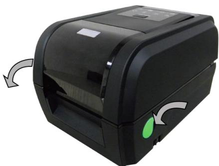
1. 依图示箭头方向，双手开启左右两侧的上盖开启钮并掀起上盖至最大的角度为止。
