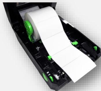
4. 将标签纸打印面朝上拉出，经过标签传感器并拉过橡胶滚轮。
