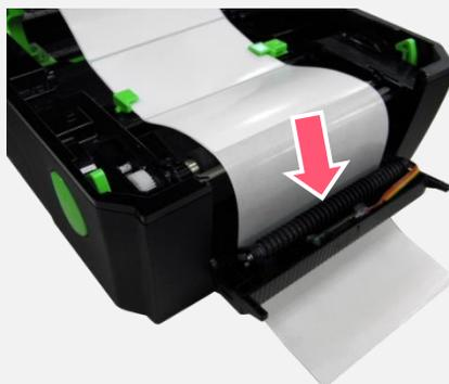
4. 开启剥纸器面板。将底纸穿过剥纸滚轮下方的底纸出纸口。
