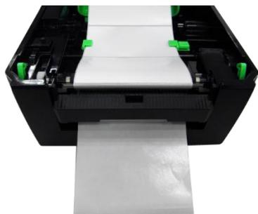
5. 将剥纸器面板和打印机上盖关闭。使用软件/硬件校正并将打印后动作设为剥纸模式。(参阅章节 4、5)
