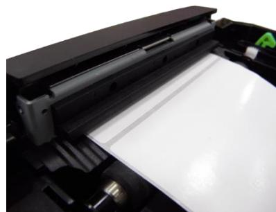
2. 将标签纸前端穿过切刀出纸孔。
