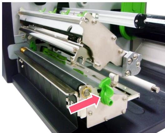
1. 开启打印机右侧掀盖。依图中箭头方向推开打印头座架释放杆，打开打印头座架。
