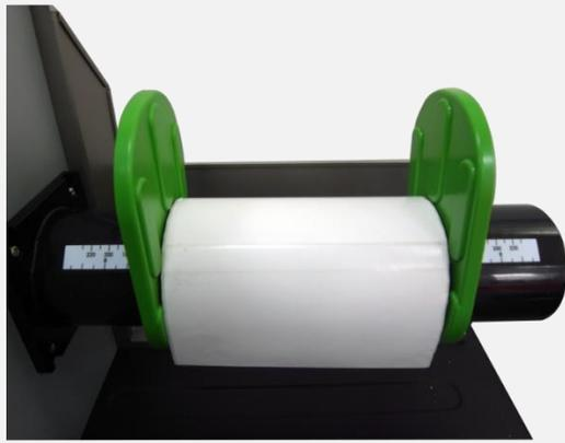
4. 将标签纸卷安装于标签供应轴，再将标签卷固定片装回并调整至适当位置使其轻触纸卷外缘。并确认标签固定片左右两外侧所看到的标签宽度值为一致的。
