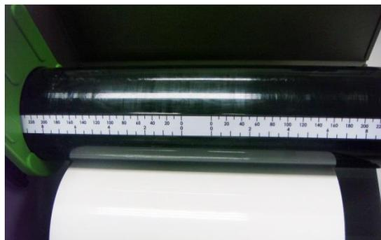
3. 量测标签纸宽度(可利用标签轴上的刻度确认)
