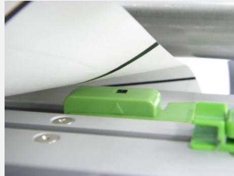
6. 此机种的标签传感器是可移动式的，请确认纸张的间隙(或黑标)有通过该适用的传感器
